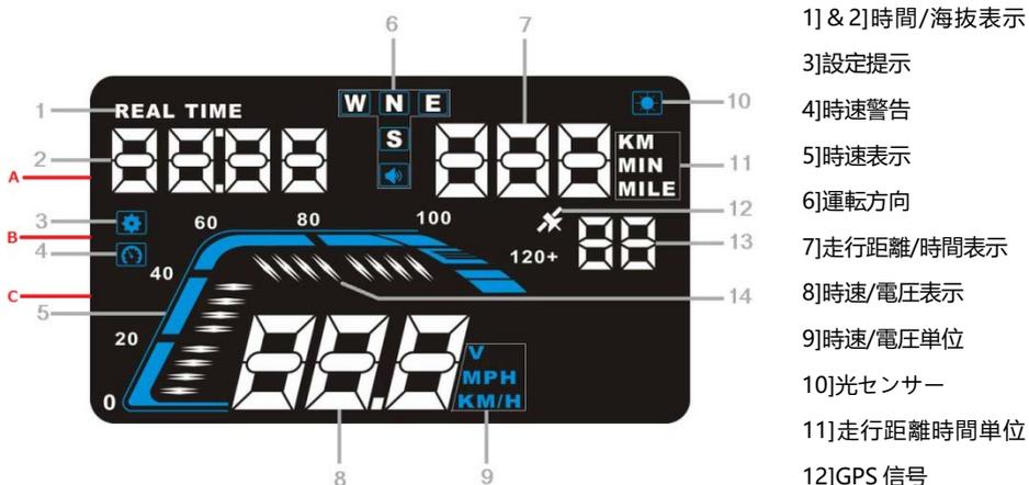
13]GPS 信号数 14]時速図形 A]電源ポート B]スイッチ C]調整ダイヤル
